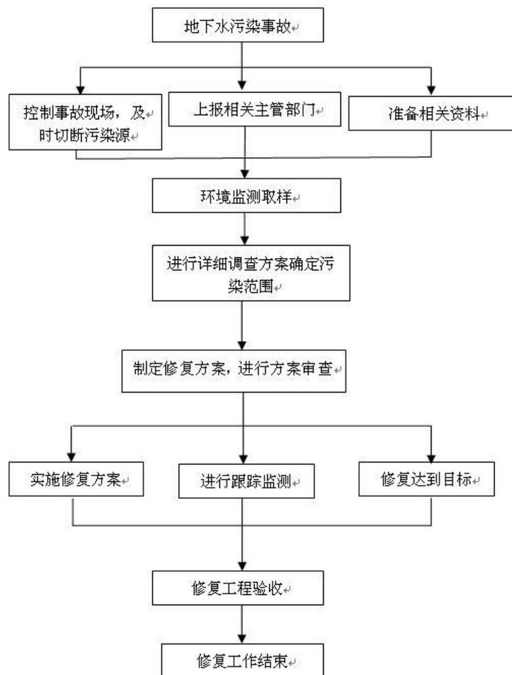
图 6.2-5 地下水污染应急治理程序
