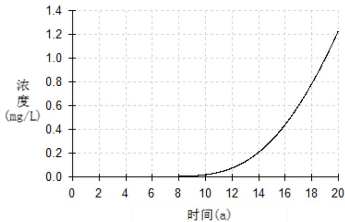
图 5.2-5 污水处理站 N1 观测点氨氮浓度变化
