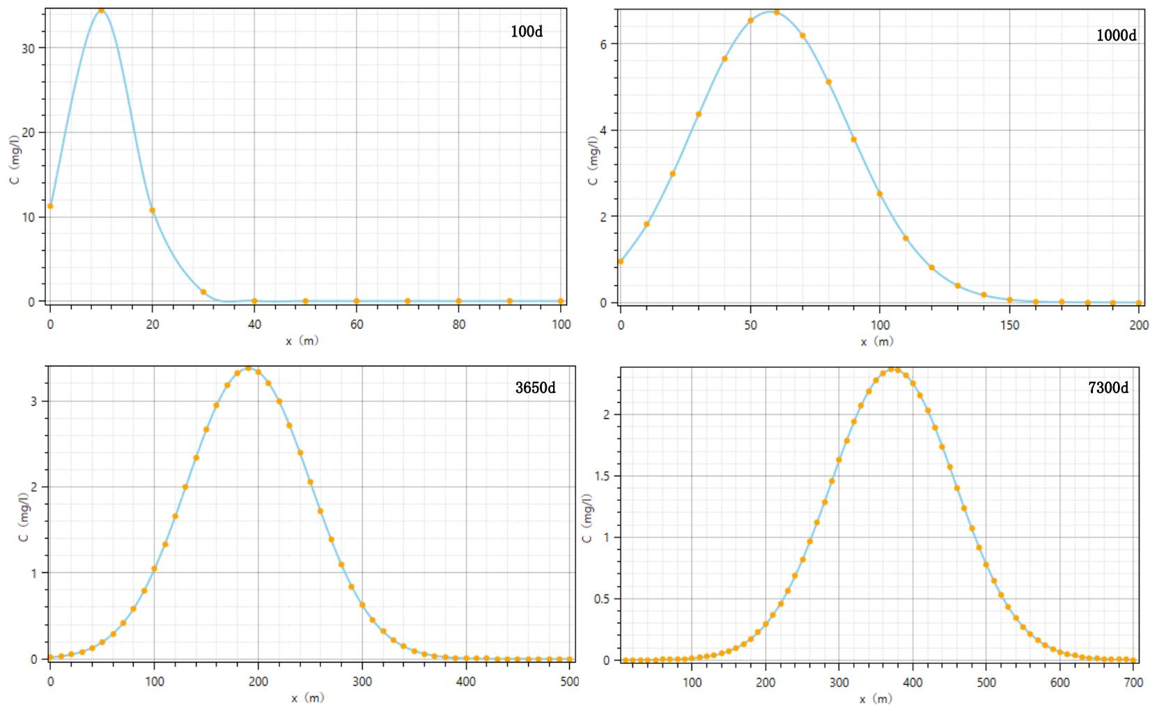
图 5.2-2 污水处理站泄漏后  $\text{COD}_{\text{Mn}}$  运移浓度曲线
